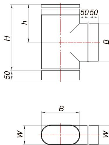
Тройник 90° с патрубком овального сечения по узкой стороне. Выполнен из нержавеющей стали.
